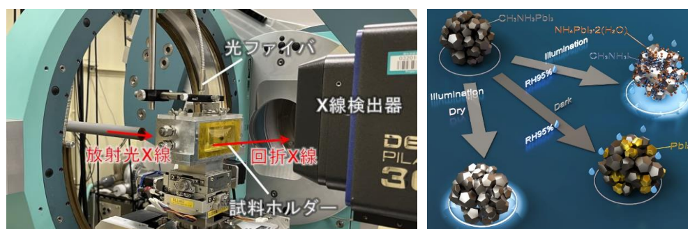
図3 劣化過程観察のために開発した測定系と、今回明らかになった複合環境下における \text{CH}_3\text{NH}_3\text{PbI}_3 の劣化過程
