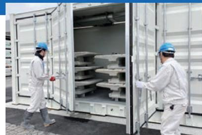
CO<sub>2</sub>-SUICOM炭酸化養生槽のイメージ
