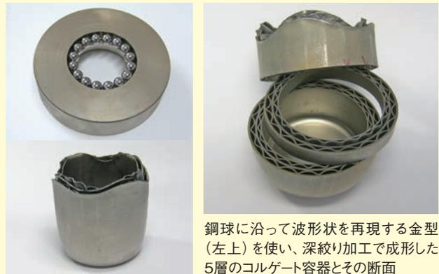
鋼球に沿って波形状を再現する金型（左上）を使い、深絞り加工で成形した5層のコルゲート容器とその断面
