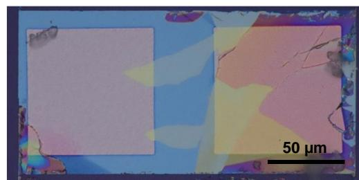
図6 作製したトランジスタの光学顕微鏡像.
