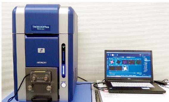
走査型電子顕微鏡(X線分析装置付)
