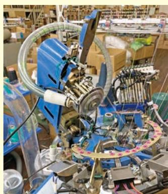
靴下編み機を開いた状態。上部から給糸された糸を筒状に編んでいく構造で、生地<sup>しじょう</sup>の内部で回転刃が回ることによって柄の裏側の糸をカットします
