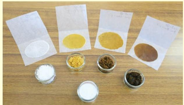
PVCの粉末 (一番下) に、油の種類やつなぎ合わせた物質により異なる4種類のサブを添加し、加熱圧縮して形成した膜 (一番上)。
