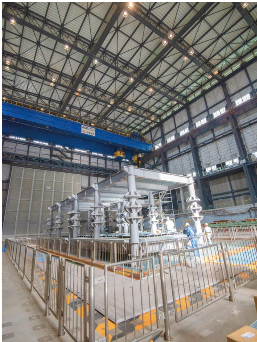
実験棟の内部。震動台上に試験体を設置する作業が進んでいました
