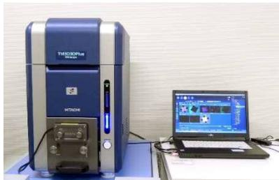
非蒸着で二次電子像や反射電子像の観察ができ、低真空下で組成分析も可能。
