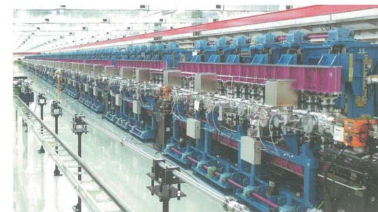
X線レーザーを生み出す真空封止型アンジュレーター
