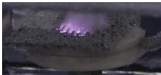
図8 多孔質セラミックス電極を用いた液中プラズマ生成の様子。
