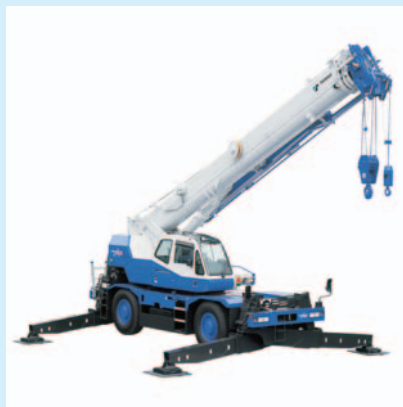
建設用クレーン車
