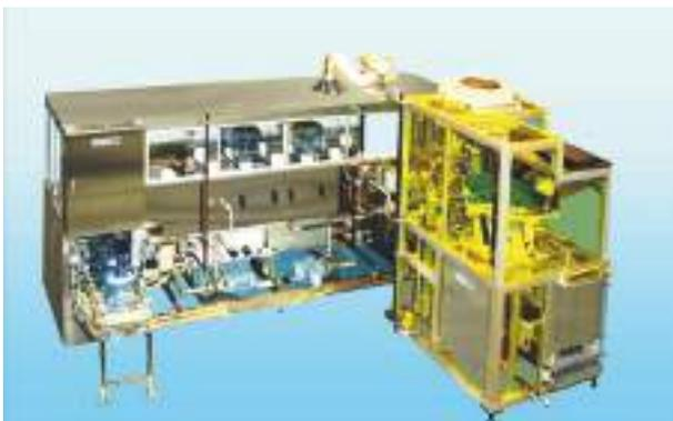
リンサ&フィラ（ボトル洗浄充填装置）
