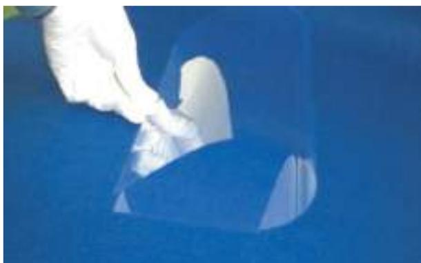
エッチングによる極薄ガラス（50μm）
