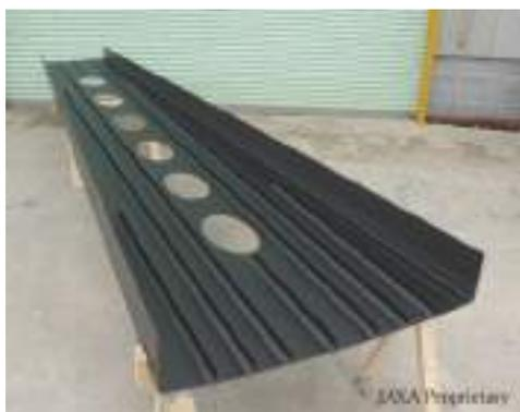
[ 6m 主翼構造供試体 VaRTM成型 ]
