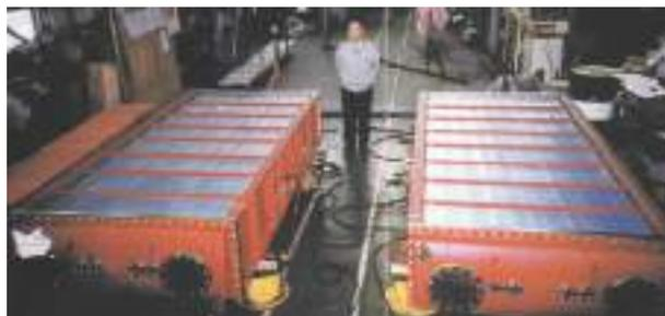
タービン発電機用熱交換器
