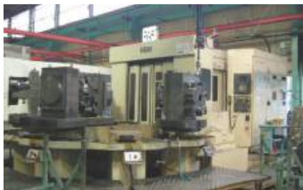
多面バレットによるエンジンハウジングの加工
