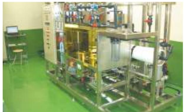
RO装置（逆浸透膜浄化装置）
