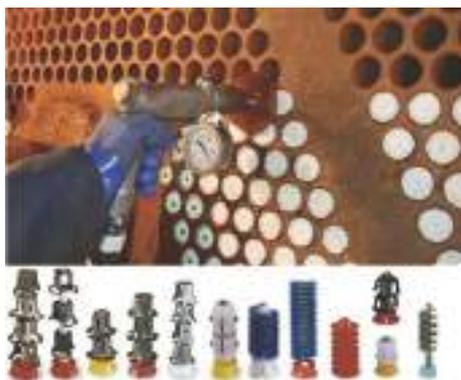
細管洗浄具のラインナップと作業風景
