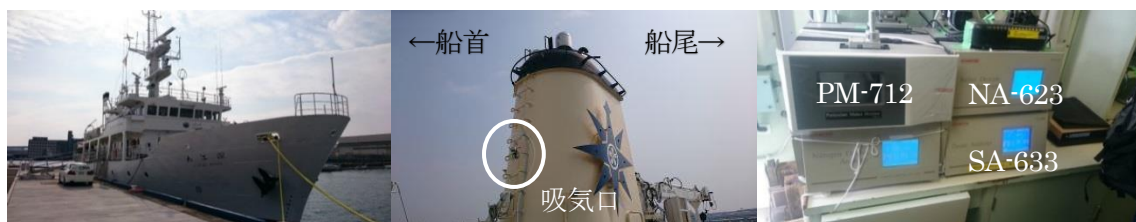
図 1 深江丸及び観測機材の設置状況（左；深江丸、中；吸気口位置、右；観測機材）
