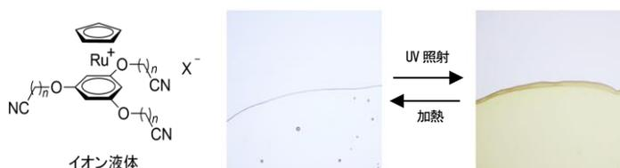
図 1. (a) 光硬化を起こすイオン液体の構造式。(b) 液体の光硬化前後の写真。左が液体、右が固体。石英板の下半分に液体がはさんである。
