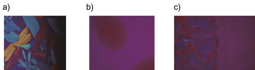
図4. 光反応生成物の偏光顕微鏡写真。(a) 密閉系、(b) 開放系、および(c) 左半分のみを石英ガラスで覆った状態で光照射した場合の生成物。
