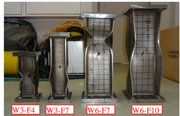
写真-1 試験終了後の変形状況
