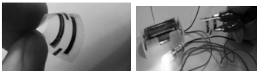
図 11. プラスチック基板の上に室温乾燥させた金ナノ粒子(Au-MSA)インク
