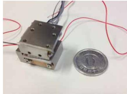
図7：作製した piezo 駆動ステージ
