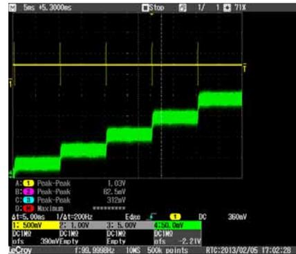
図8： piezo 素子への印加電圧(上)とエンコーダ出力(下)
