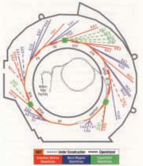
放射光源ALS電子蓄積リングの平面図。電子ビームを強く曲げる超伝導ウィグラーが3つの緑色の四角形で示されている。
