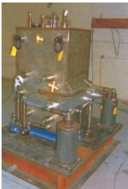
電子蓄積リングに挿入される超伝導ウィグラー
