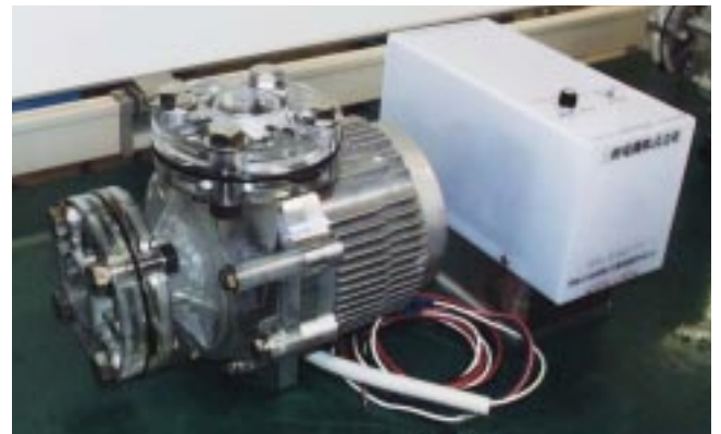
平成11年度助成企業：三相電機(株) 「ダイレクトドライブ方式の直流マグネットポンプの開発」
